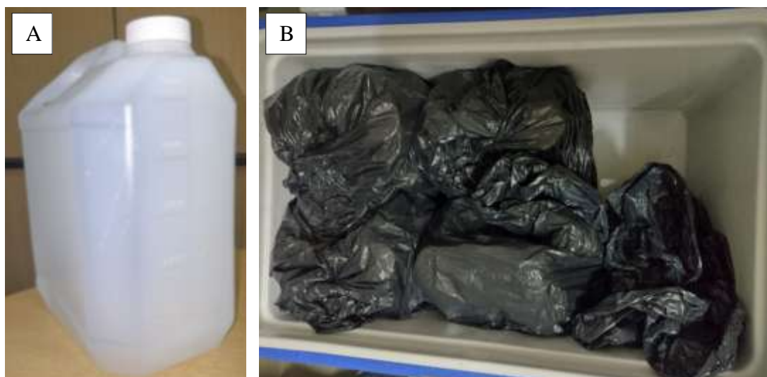
Figura 2: A- envase sugerido de plástico (PEAD) tipo bidón de 5 L. B- condiciones de conservación de muestras, cubiertas (oscuridad) y refrigeradas.
