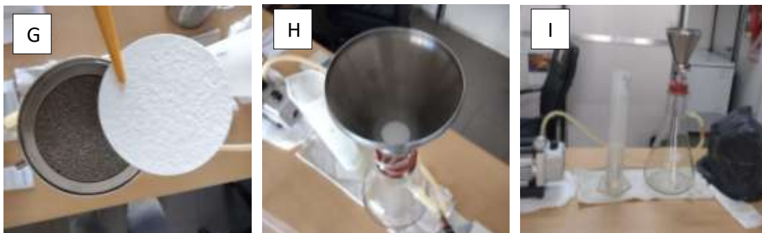
G- colocación del filtro sobre la placa filtrante. H- montaje del embudo sobre el soporte. I- montaje completo del sistema de filtrado, conectado a la bomba de vacío.
